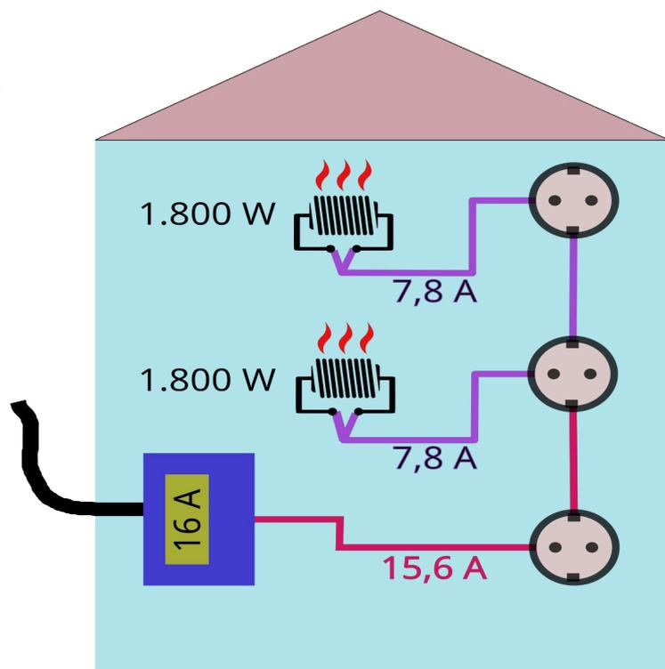
seien hier mal die mit dem üblichen Leitungsquerschnitt von 1,5 mm<sup>2</sup>, die sind nach VDE-Norm bis 18 Ampere belastbar (allerdings dürften sie dann auch schon leicht warm werden). Zu sehen ist hier schnell, dass in Summe ab der zweiten Steckdose ordentliche 15,6 Ampere fließen, der Leitungsschutz (im Volksmund auch „Sicherung“) wird aber ohne Probleme halten in dieser Situation, das auch auf Dauer.
