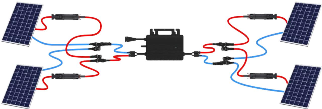
(Die Y-Adapter können auch direkt am Wechselrichter angeschlossen sein, das passte nur nicht gut in die Graphik oben :)) Der große Vorteil dieser Schaltung ist aus meiner Sicht, dass Du damit wirklich jedes der vier Module anders ausrichten kannst. So könntest Du vier Module rund um den Balkon positionieren und hättest den ganzen Tag eine passable Leistung. Ein Beispiel aus dem Ahrtal sieht so aus:
